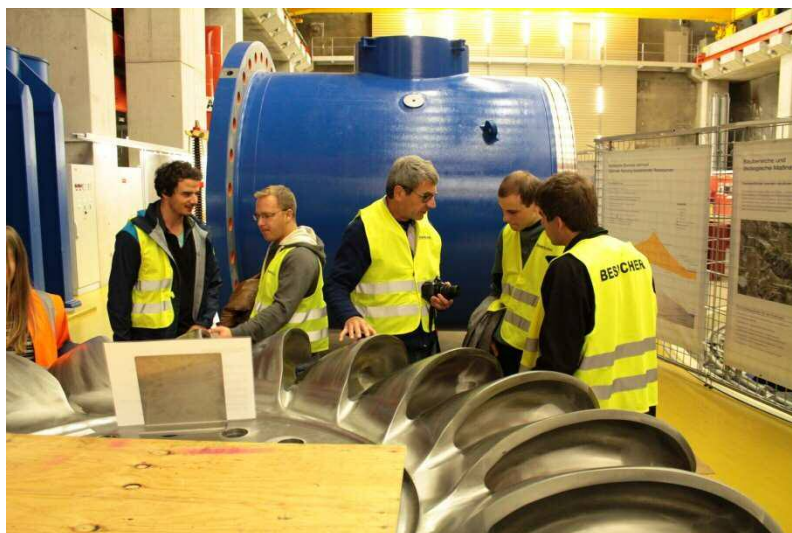
Bild 1: Ersatz-Laufrad des Wasserkraftwerkes Kops II
