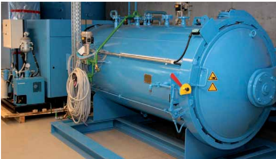
An der Fakultät Maschinenbau der HS.R: Insgesamt zwei Tage hat es gedauert bis die acht Tonnen schwere Heißluftautoklavanlage seinen Standort im Labor für Faserverbundtechnik eingenommen hat. Foto: Feuerer
